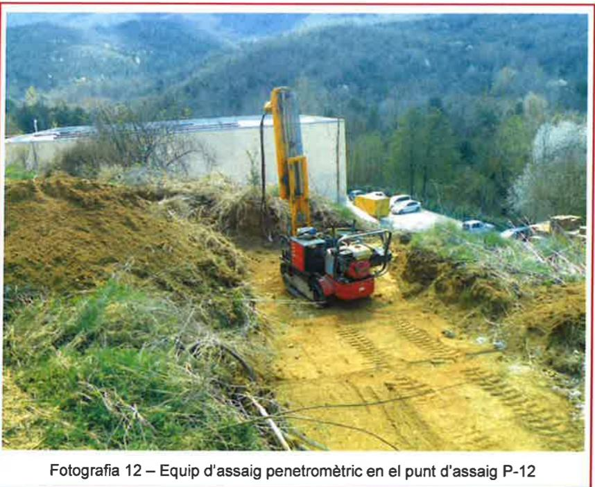
Fotografia 12 – Equip d'assaig penetromètric en el punt d'assaig P-12
