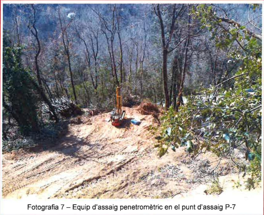
Fotografia 7 – Equip d'assaig penetromètric en el punt d'assaig P-7
