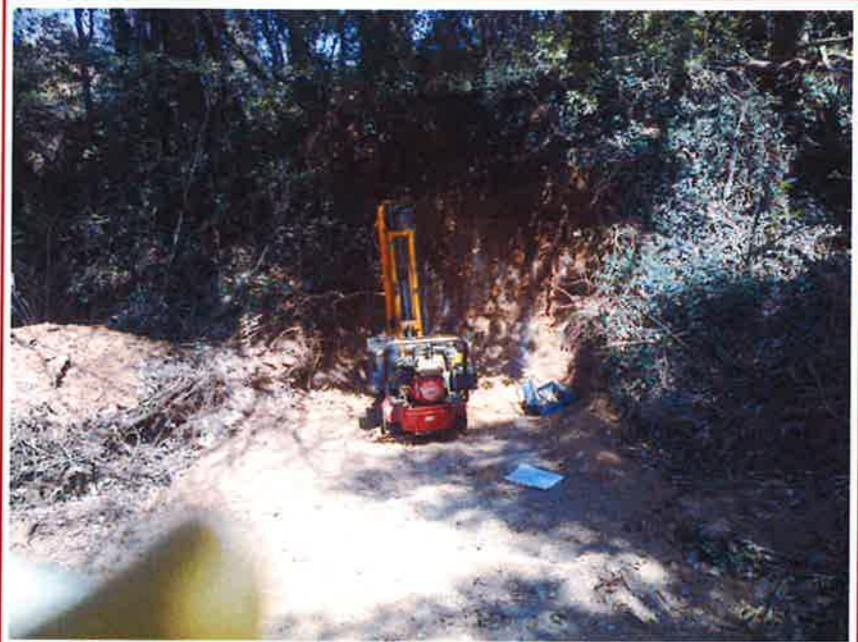
Fotografia 10 – Equip d'assaig penetromètric en el punt d'assaig P-10
