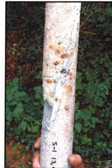
A l'esquerra vista d'un aflorament dels materials de la capa A2, amb diversos plans de fractura mesurables. A la dreta, detall del testimoni del sondeig S-1 que travessa una zona de falla molt alterada
