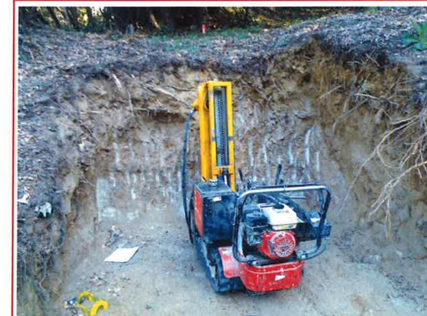
Fotografia 1 – Equip d'assaig penetromètric en el punt d'assaig P-1
