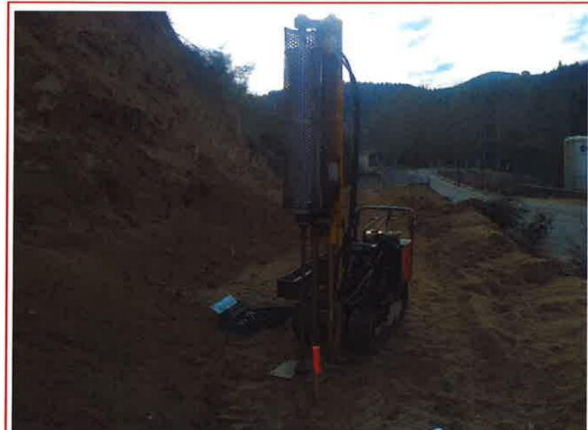
Fotografia 13 – Equip d'assaig penetromètric en el punt d'assaig P-13
