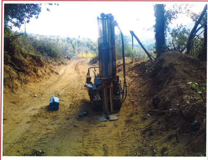
Fotografia 11 – Equip d'assaig penetromètric en el punt d'assaig P-1
