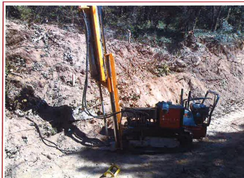
Fotografia 6 – Equip d'assaig penetromètric en el punt d'assaig P-6
