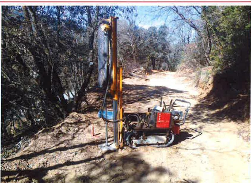
Fotografia 4 – Equip d'assaig penetromètric en el punt d'assaig P-4
