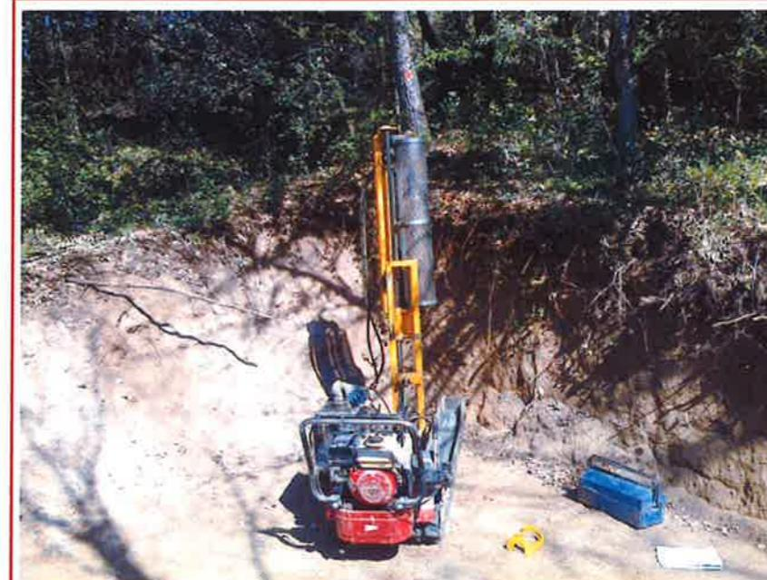
Fotografia 5 – Equip d'assaig penetromètric en el punt d'assaig P-5
