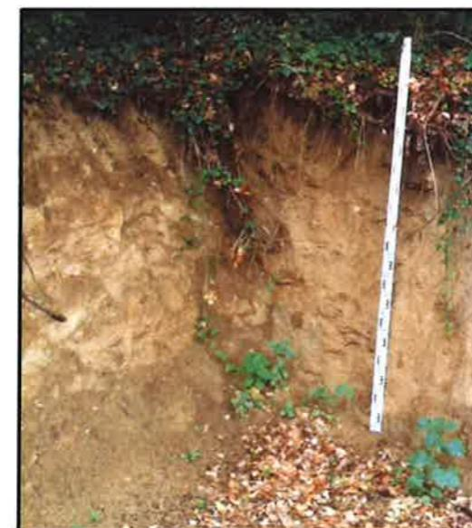
Detall d'alguns afloraments dels materials de la capa A<sub>1</sub>. Visualment conserven l'estructura de la roca granítica, però es poden excavar fàcilment i es desgranen superficialment en forma de sorres.
