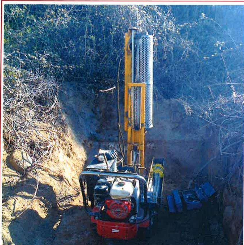
Fotografia 15 – Equip d'assaig penetromètric en el punt d'assaig P-15
