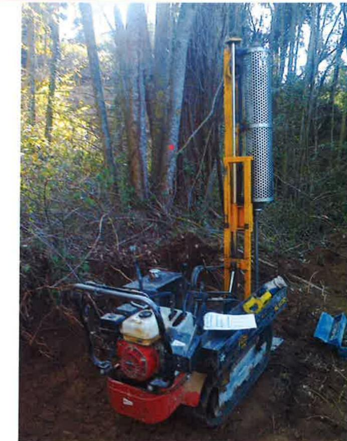
Fotografia 14 – Equip d'assaig penetromètric en el punt d'assaig P-14
