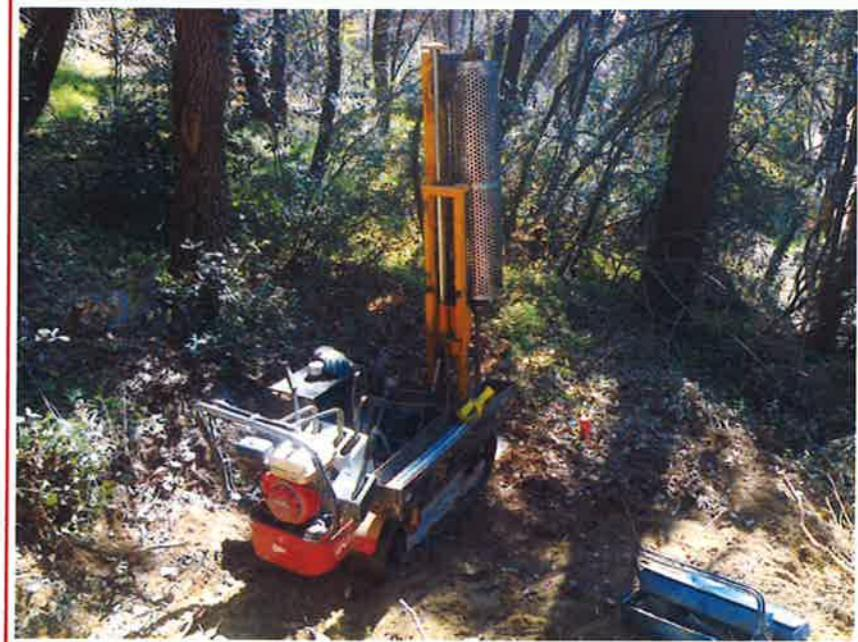
Fotografia 9 – Equip d'assaig penetromètric en el punt d'assaig P-9
