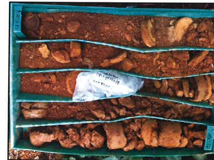
Detall dels tres primers metres del sondeig S-1, constituïts per materials sorrencs de sòl d'alteració.
