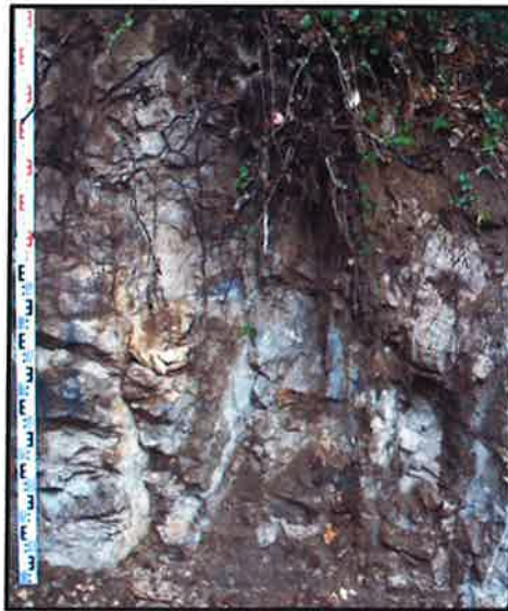
A l'esquerra vista d'un aflorament dels materials de la capa A2, amb diversos plans de fractura mesurables. A la dreta, detall del testimoni del sondeig S-1 que travessa una zona de falla molt alterada
