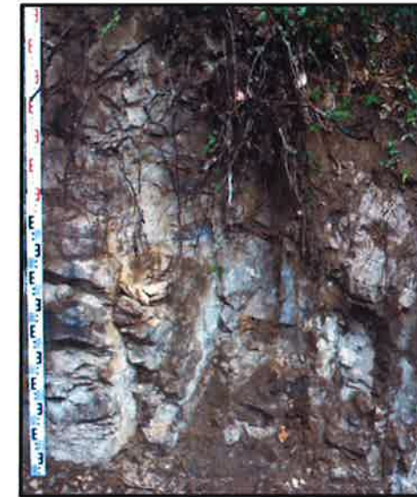
A l'esquerra vista d'un aflorament dels materials de la capa A 2 , amb diversos plans de fractura mesurables. A la dreta, detall del testimoni del sondeig S-1 que travessa una zona de falla molt alterada
