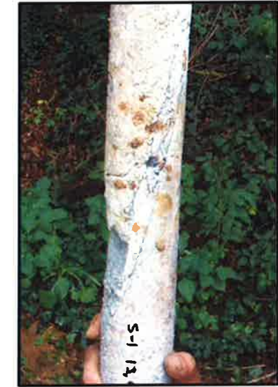
A l'esquerra vista d'un aflorament dels materials de la capa A 2 , amb diversos plans de fractura mesurables. A la dreta, detall del testimoni del sondeig S-1 que travessa una zona de falla molt alterada
