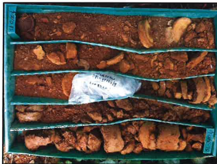
Detall dels tres primers metres del sondeig S-1, constituïts per materials sorrenca de sòl d'alteració.
