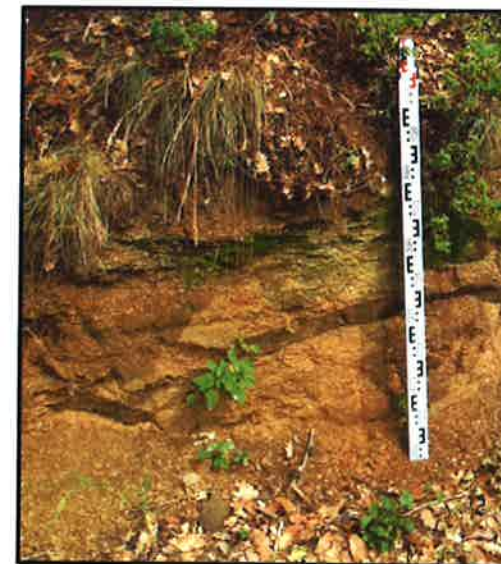
Detall d'alguns afloraments dels materials de la capa A 1 . Visualment conserven l'estructura de la roca granítica, però es poden excavar fàcilment i es desgranen superficialment en forma de sorres.
