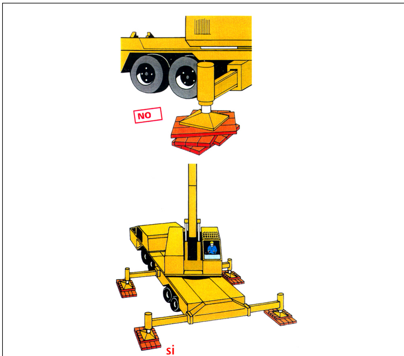
Col·locació estabilitzadors recolçaments
