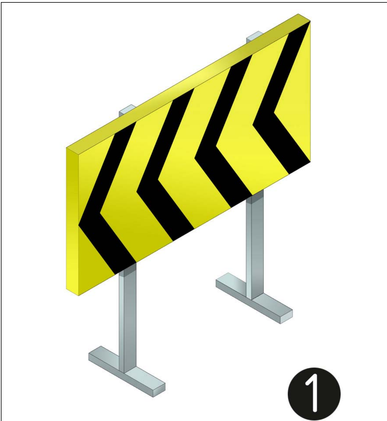
1. plafó desviament de trànsit
